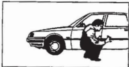
Dopo aver montato tutte le parti, pressate ancora una volta fortemente sulle strisce e non sbattete le portiere per almeno 24 ore. Voi sarete così sicuri di una adesione ottimale.
