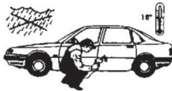
ACHTUNG: die Zierleisten nicht bei einer Temperatur unter 18°C montieren. Wenn die Montage doch notwendig sein sollte, dann beide Komponenten kurz mit einem Fohn erwärmen (Leisten und Karosserie).
