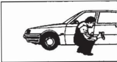
Pulite bene la superficie di montaggio con alcool.
