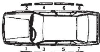
Legen Sie die Teile links und rechts in der richtigen Reihenfolge ohne die Schutzfolie zu entfernen.
